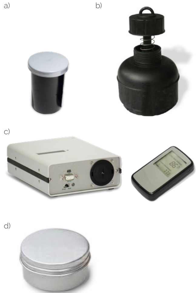
Figura 7 - Detectores más habituales: a) detector de trazas; b) electrete; c) dispositivos electrónicos; d) detector de carbón activo
